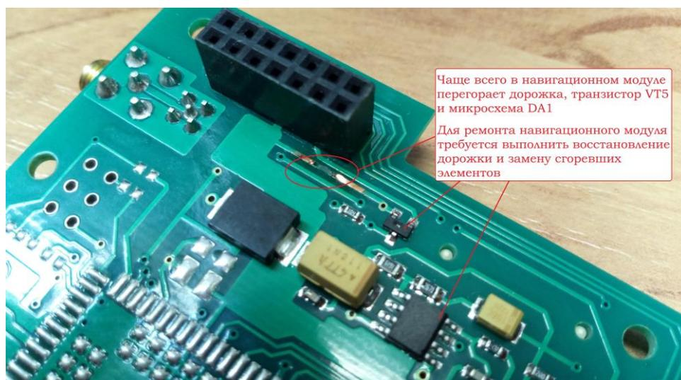
3. Если навигационный модуль исправен - требуется проверить блок СКЗИ. Для этого его необходимо демонтировать и установить на заведомо рабочий тахограф. Если на рабочем тахографе так же возникает ошибка СКЗИ 02 – блок СКЗИ неисправен.
