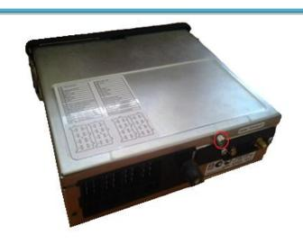
Снять верхнюю крышку тахографа
